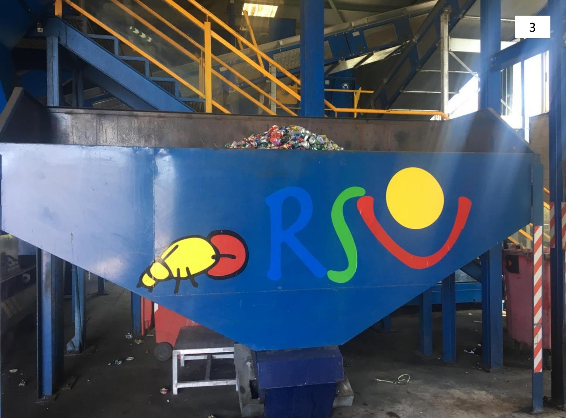
Con esta implementación hemos logrado optimizar el proceso de captación de aluminio, ya que nos permite almacenar una mayor cantidad de aluminio para luego trasladarlo a la prensa de chapajo (imagen nº4).
