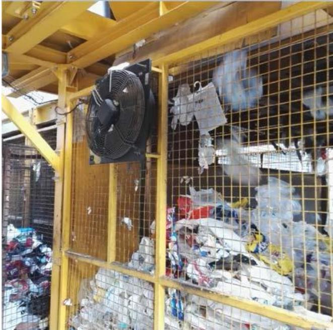
Tras la instalación del ventilador el sistema facilita un óptimo aprovechamiento de la capacidad de almacenamiento de troje, garantizando una cantidad almacenada suficiente para poder formar una bala completa en el momento de prensado.
