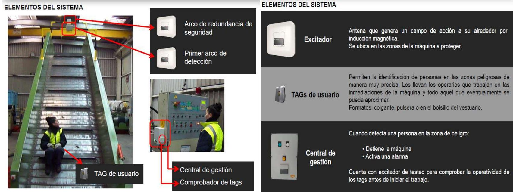
Este equipo funciona de modo que el operario lleva colgando el emisor y el receptor se ubica en un arco sobre la cinta de manera que en caso de desfallecimiento del operario y caída sobre la cinta, el emisor al entrar en el radio de acción del receptor (1-2 metros) es detectado por éste activando la señal para que se produzca el paro de la cinta al estar el equipo enclavado con el armario eléctrico que controla el funcionamiento de la cinta, generando una señal de alarma.
