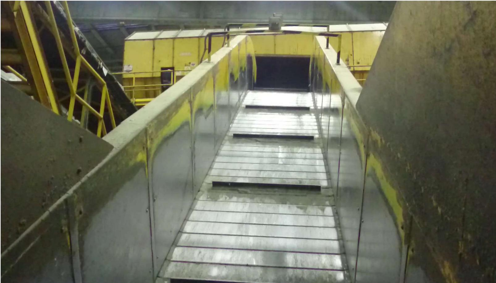
El dispositivo de paro de maquina se encuentra plenamente operativo y con su puesta en funcionamiento se ha conseguido minimizar el riesgo de atrapamiento en la cámara de la prensa de embalaje.
